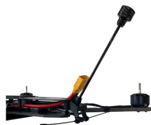
Установите на самый край антенны резиновую накладку, затем с особой осторожностью воткните ее в каркас. Для окончательной установки плотно затяните антенну на накладку.
